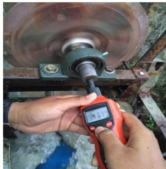
Gambar 9. Pengukuran rpm generator.
