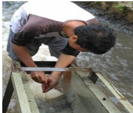
Gambar 6. Pengukuran ketinggian muka air sebelum munumbuk sudut.
